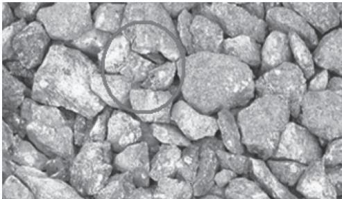
Рис. 2. Раздавливание щебенки на поверхности щебеночного слоя со степенью уплотнения, которая соответствует динамическому модулю деформации 45–50 МПа
