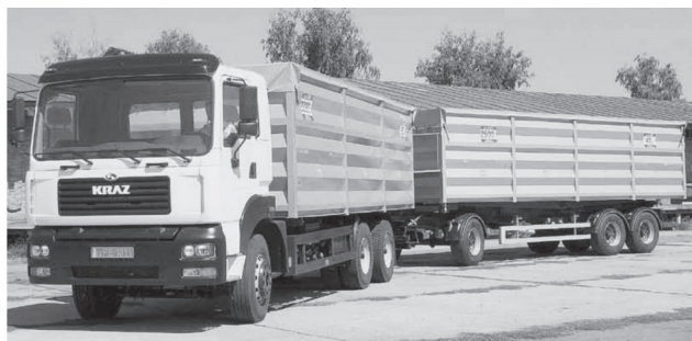
Рис. 2. Автопоїзд-зерновоз КрАЗ “КАРАВАН-2” у складі автомобіля-самоскида КрАЗ-6511С4 та причепа-самоскида РСWІ 33
