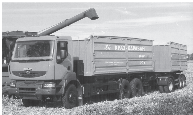
Рис. 1. Автопоїзд-зерновоз КрАЗ “КАРАВАН-1” у складі автомобіля-самоскида КрАЗ-6230С4 та причепа-самоскида КрАЗ-А261С3
