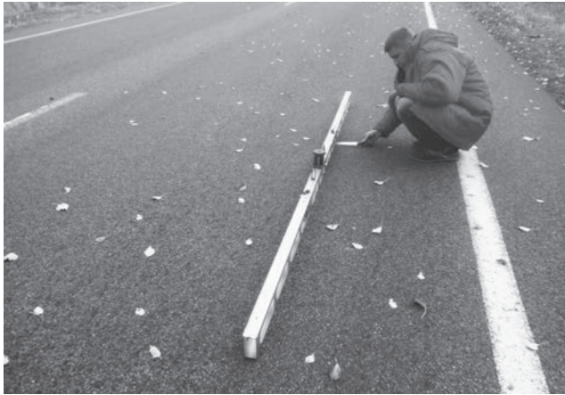
Рис. 3. Вимірювання поздовжньої рівності покриття по смузі нахату на ділянці а/д М-02 Кіпті – Глухів – Бачівськ, км 100+300, правий проїзд
