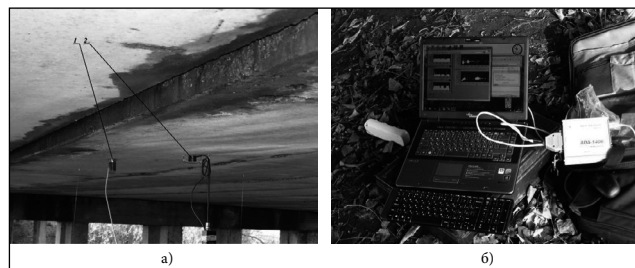
Рис. 3. Обладнання для проведення випробувань прогонової будови моста: а) розташування перетворювачів ПАЕ та ПВАЕ на поверхні плити, де 1 — перетворювач віброакустичної емісії (ПВАЕ), 2 — перетворювач акустичної емісії (ПАЕ); б) обладнання для реєстрації віброакустичних сигналів
