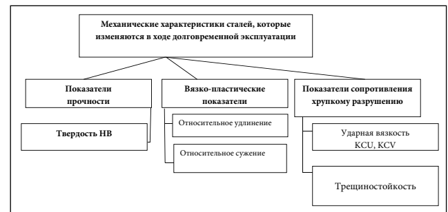
Рис. 4. Механические свойства сталей, которые изменяются в процессе длительной эксплуатации
