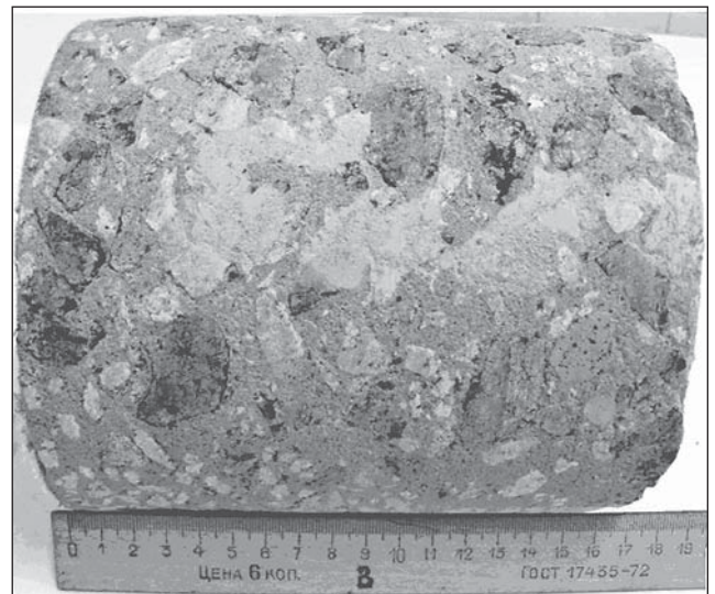
Рис. 2. Керн з пісного бетону, випиляного з основи через 18 годин
