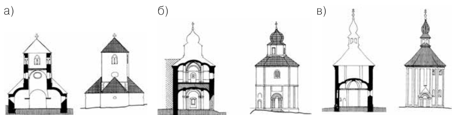
Рис. 8. Романські двоярусні квадрифолії: а) Хрест над Горнадом. Перетин та фасад. Словаччина (за В. Менцлом); б) Як. Перетин та фасад. Угорщина (за В. Герверс-Мольнар); в) Папоц. Перетин та фасад. Угорщина (за В. Герверс-Мольнар)
