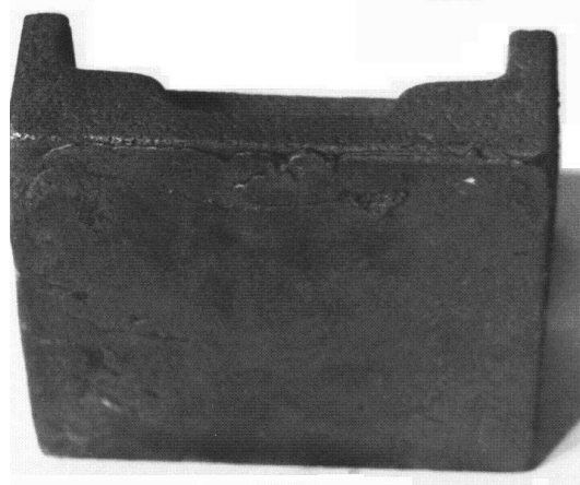
Рис. 3. Якісна поверхня сталевого відливка.
