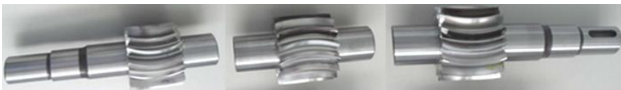
Рис. 5. Дослідні зразки зубчастих коліс з симетричними арковими зубцями
