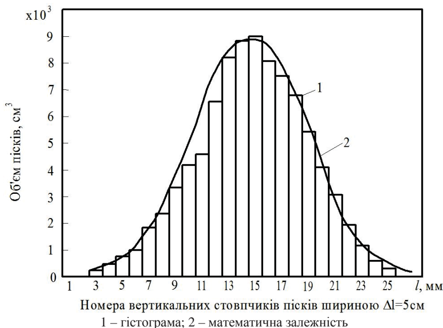
Рис.5 – Значення об'єму матеріалу в вертикальних стовпчиках і аналітична залежність, що характеризують закономірність розташування матеріалу вздовж нижньої частини пісового тіла механічного спірального класифікатора
