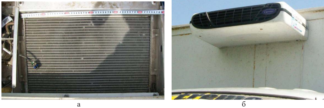
Рис. 1 – Експериментальна модель: а – мікроканальний повітряний конденсатор; б – транспортна холодильна установка
