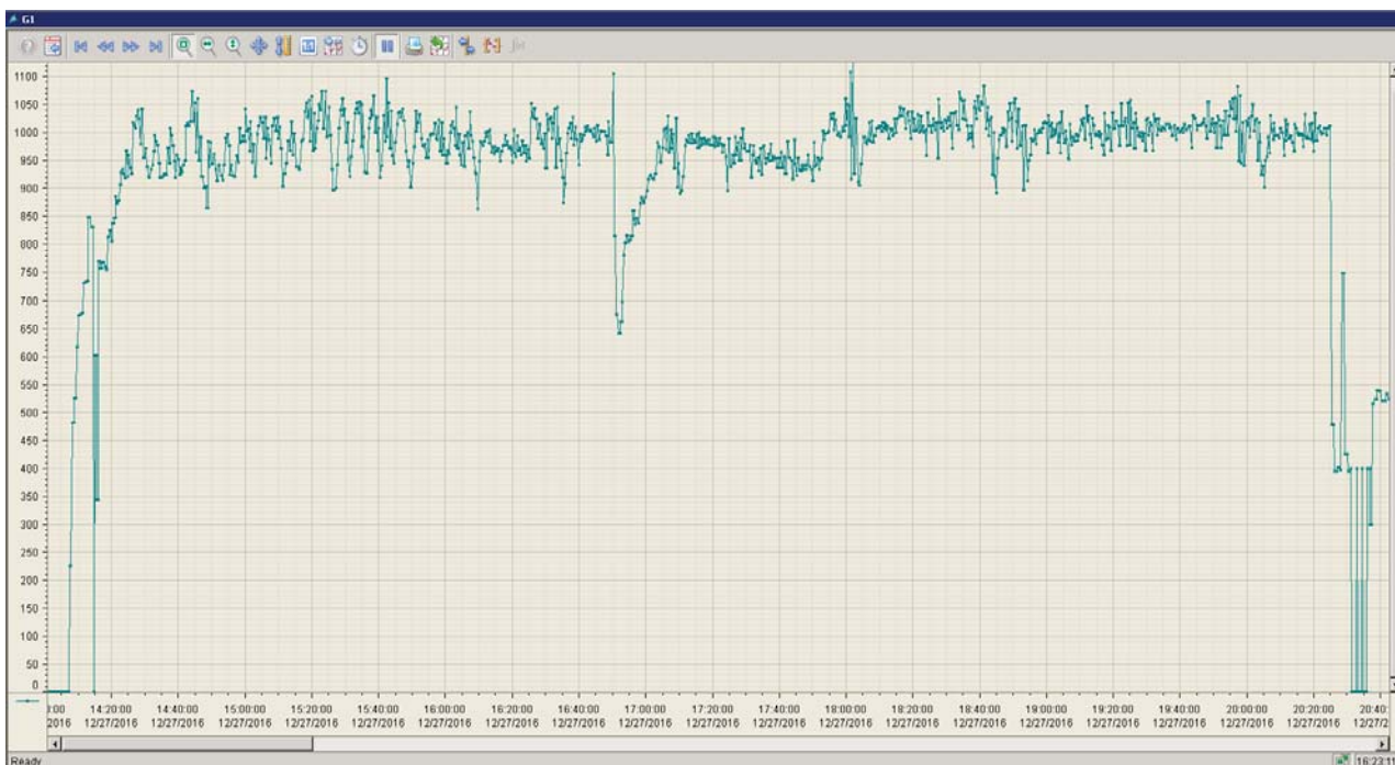
Рис. 6 – Фрагменты изменения производительности ПТЛ под управлением АСОЗ (Ca1.1), интервал времени 8 часов.
