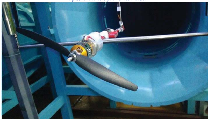
Рис.4 – Эксперимент для получения аэродинамических свойств воздушных винтов
