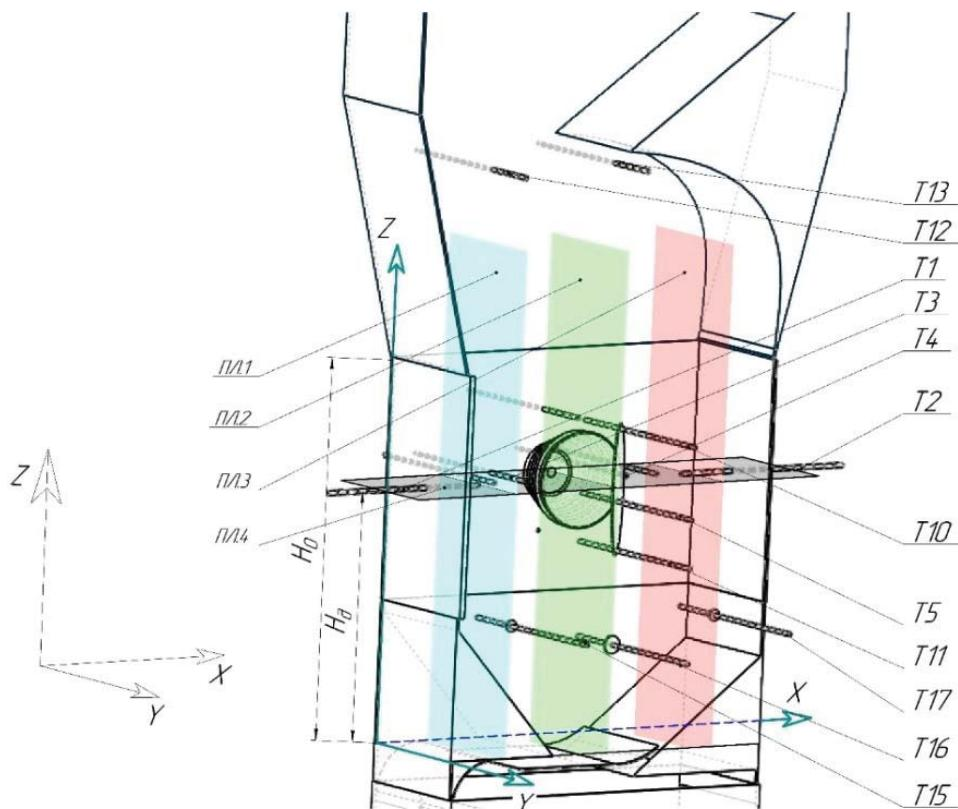
**Рис. 7 – Схема розміщення треків термопар в камері гранулятора**
