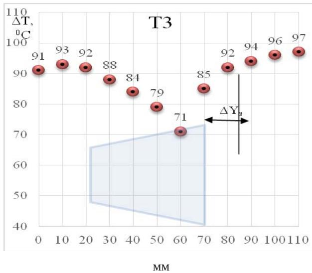
Рис. 8 – Зміна температури в площині на межі зони I i II при X=100 мм, 0 ≤ Y ≤110 мм, Z = 220 мм, T3
