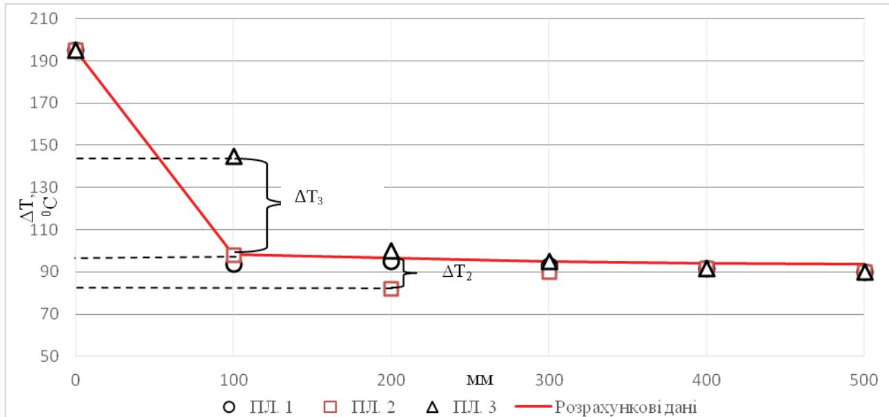
Рис. 14 – Зміна температури теплоносія по висоті апарату в площині
