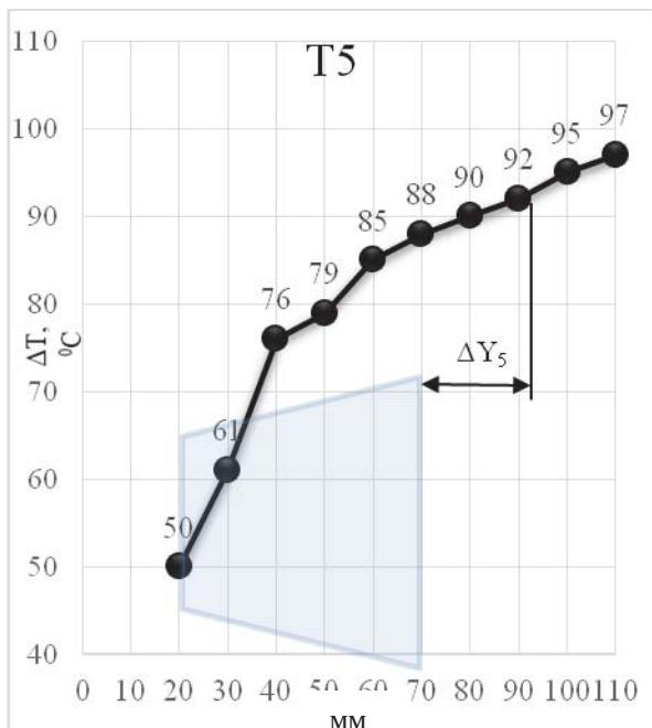
Рис. 12 – Зміна температури в частині диспергатора площини 3 при  $X = 150$  мм,  $30 \leq Y \leq 110$  мм,  $Z = 210$  мм
