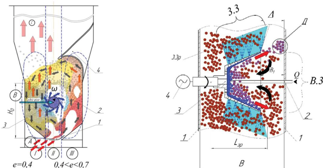
a) Схема взаємодії газового суцільного середовища із зернистим матеріалом
