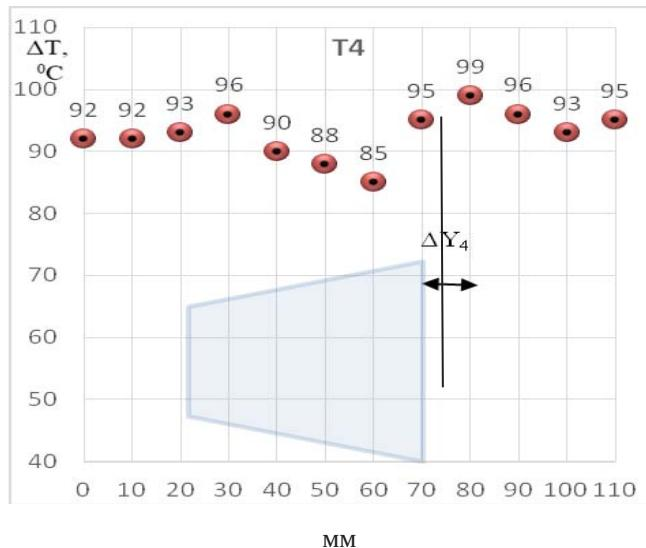
Рис. 9 – Зміна температури в висхідній площині А при X=200 мм, 0 ≤ Y ≤110 мм, Z = 220 мм, T4
