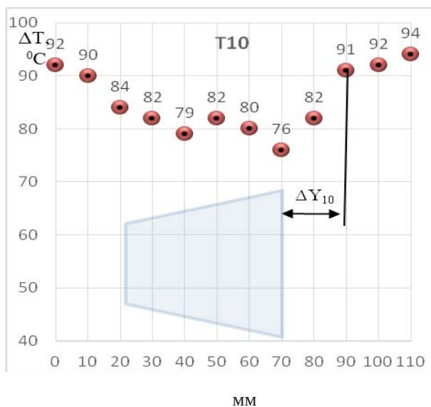
Рис. 10 – Зміна температури в підхідному потоці площини А при X= 150 мм, 0 ≤ Y ≤110 мм, Z = 270 мм, T10
