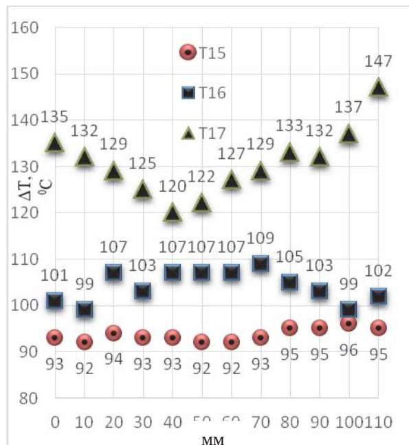
Рис. 13 – Зміна температури в ПЛ 1 при  $mm$ , ПЛ 2 при  $X = 150$  мм,  $0 \leq Y \leq 110$  мм,  $Z = 90$  , ПЛ 3 при  $X = 250$  мм,  $0 \leq Y \leq 110$  мм,  $Z = 110$  мм
