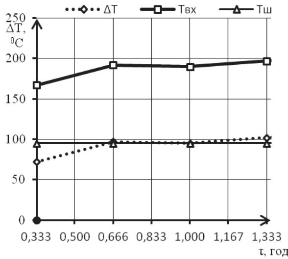
Рис. 4 – Динаміка зміни температури теплоносія на вході та в камері апарату
