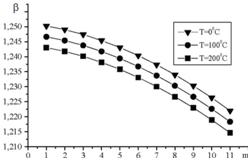
Рис. 1 – Постоянные распространения  $\beta$  мод ОВ  $AgClBr$  с параметрами:  $2a = 100$  мкм,  $n_1 - n_2 = 0,05$ ; для холодного состояния волокна ( $T = 0$ ), и нагретого на  $100$  и  $200^{\circ}\text{C}$ .
