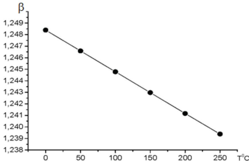
Рис. 2 – Температурный сдвиг постоянной распространения  $\beta_{0l}(T)$ , мкм<sup>-1</sup>, для одномодового AgClBr волокна
