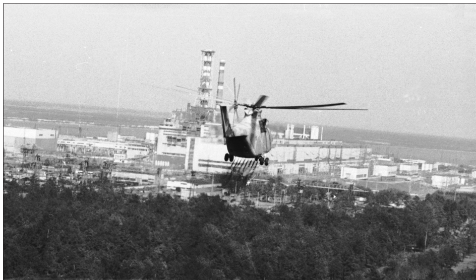
Дезактивація з повітря території 4-го енергоблоку Чорнобильської АЕС ім. В. І. Леніна. м. Прип'ять Чорнобильського району Київської обл., 17 вересня 1986 р.
