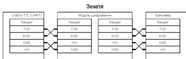
Рис. 5. Схематичне зображення підключення шифратора в розрив між наземною станцією і трансивером
