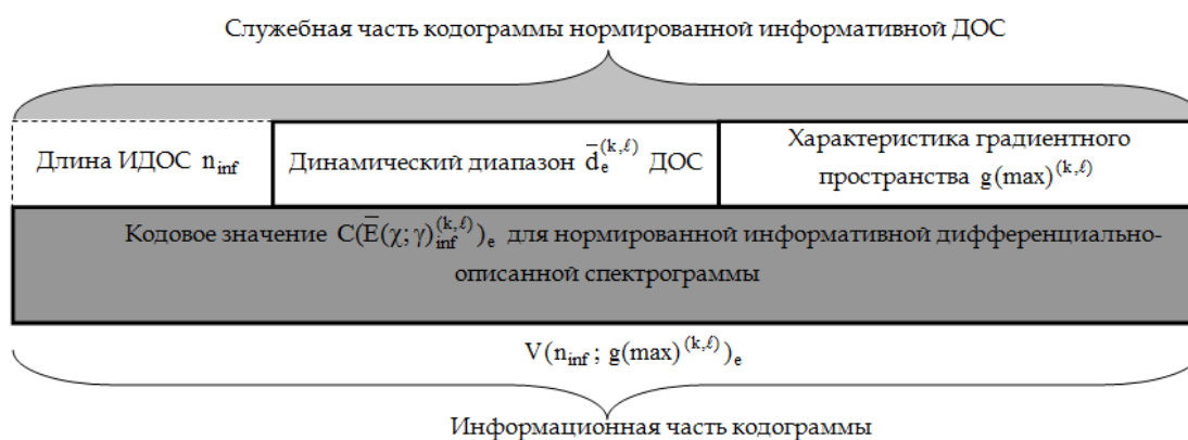
Рис. 2. Структура S(\bar{E}(\chi; \gamma)_{inf}^{(k,\ell)})_e кодограммы кодового значения (k; \ell) -й нормированной информативной ДОС в составе (\chi; \gamma) -слота последовательности Р-кадров
