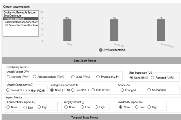
Рис. 2. Встроенный CVSS-калькулятор с графической интерпретацией CVSS метрик
