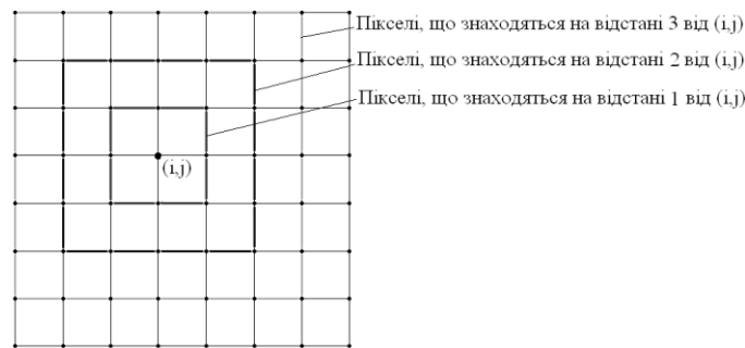
Рис.2. Місце розташування пікселів у ЦЗ, що знаходяться від заданого пікселя, що знаходиться у позиції (i, j) в матриці зображення, на відстані p, p \in \{1, 2, 3\}
