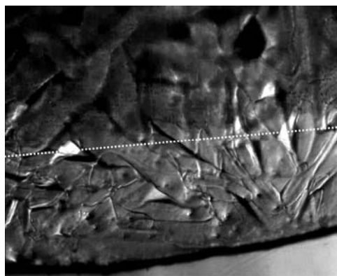
Рис. 5. Кристаллизация дисперсной фазы (выше пунктирной линии). Состояние через 55 с от состояния на Рис. 4.
