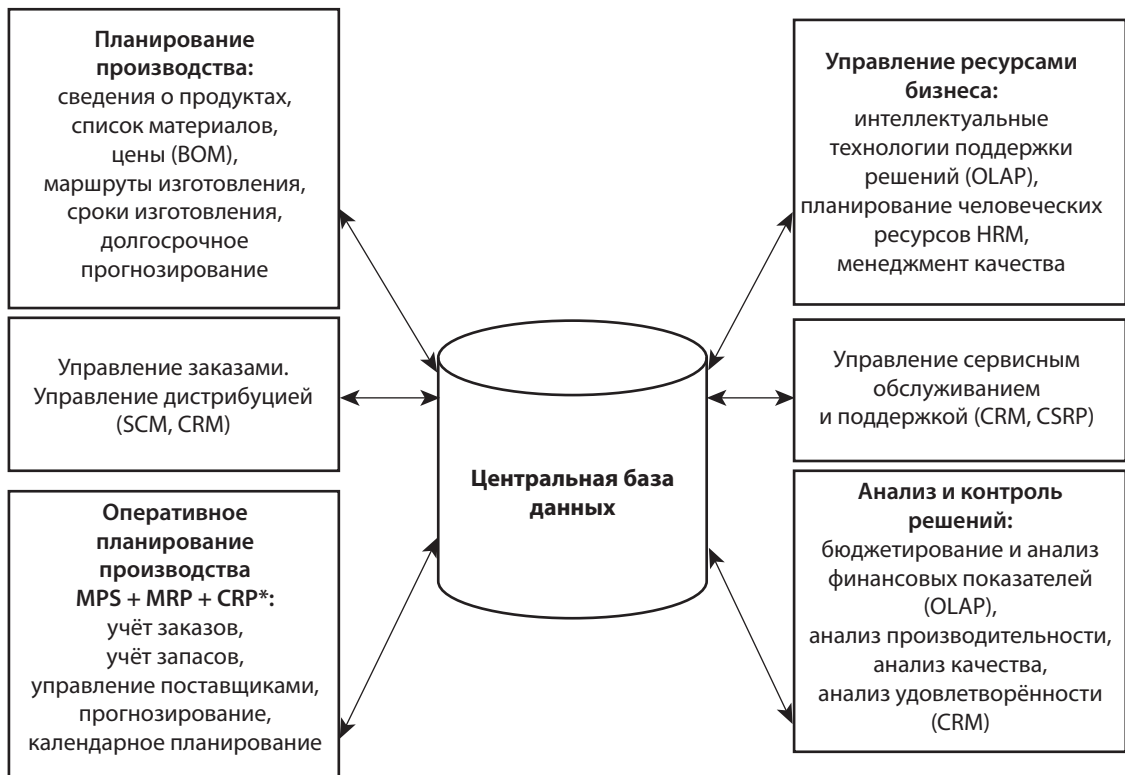
Рис. 2. Обобщенная функциональная модель ERP-систем [4]
