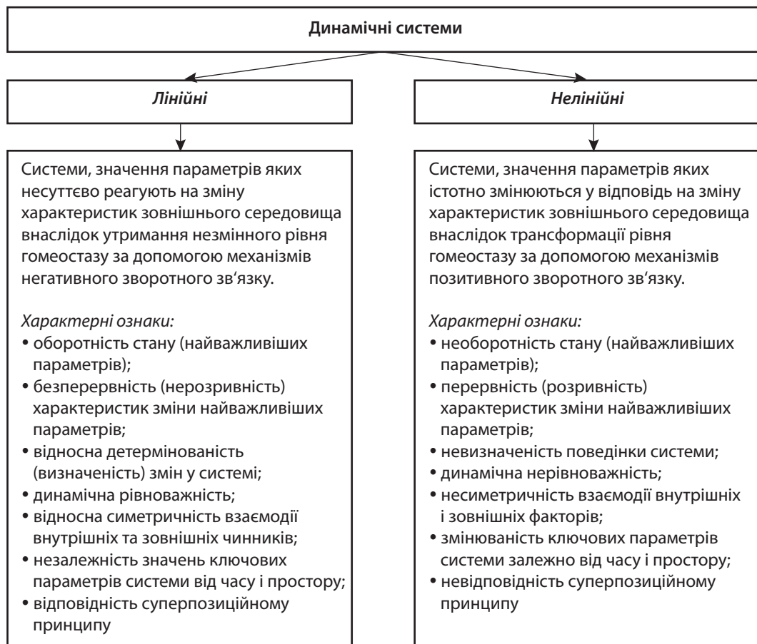
Рис. 1. Відмінності між лінійними та нелінійними динамічними системами
