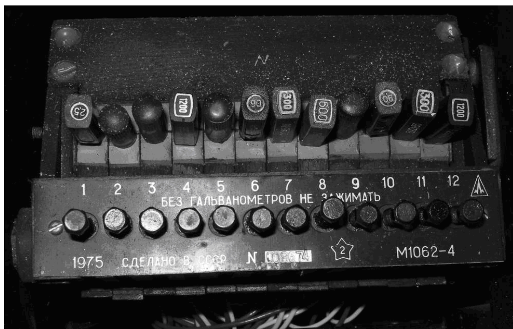
Рис. 2: Вычлененный блок зеркальных гальванометров светолучевого осциллографа, который может использоваться для Y-сканирования.
