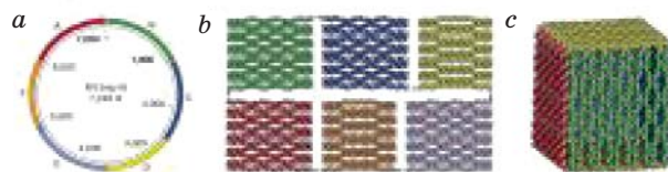
Рис. 1. Схема створення наношкатулки: a — ДНК бактеріофага M13; b — після додавання першої порції олігонуклеотидів формуються прямокутники бічних граней, які потім за допомогою другої порції олігонуклеотидів збираються у наношкатулку ( c )
