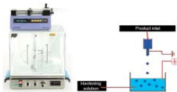
Рис. 2. Крапельний метод за допомогою електростатичної сили (з дозволу Chralampopoulos D., Rastall R.A., 2009)
