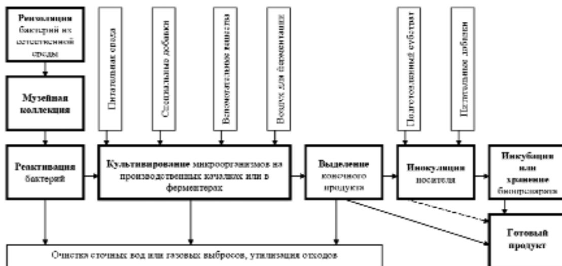
Рис. 1. Схема создания и производства биопрепаратов на основе азотфиксирующих бактерий
