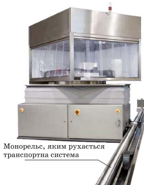
Рис. 7. Ліофільна сушарка PennTech-Autoloaders, що може обертатись
