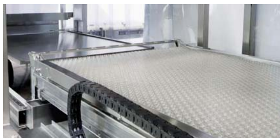
Рис. 6. Транспортування пляшечок з розчином у морозильну камеру
