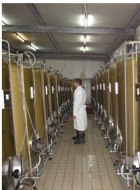
Рис. 4. Відділення доброджування у вертикальних ємностях
