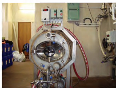
Ручна СІР-установка для миття ємностей
