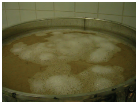
Рис. 15. Відкриті бродильні апарати приватної міні-пивоварні
