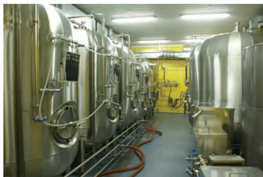
Рис. 16. Закриті чани головного бродіння на міні-пивоварні
