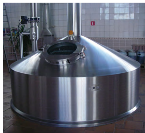
Рис. 2. Сучасний сусліварильний апарат з нержавіючої сталі
