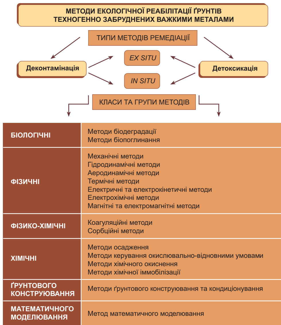
Рис. 1. Концептуальна модель диференціації відомих методів ремедіації забруднених важкими металами ґрунтів
