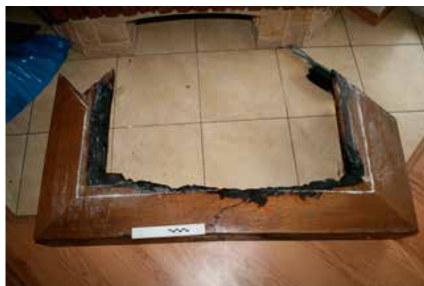
Ryc. 27, 28. Zwęglenia w wyniku pirolizy tzw. okapów kominków wykonanych z płyty wiórowej z naturalną okleiną (fot. Tomasz Wiśniewski)
