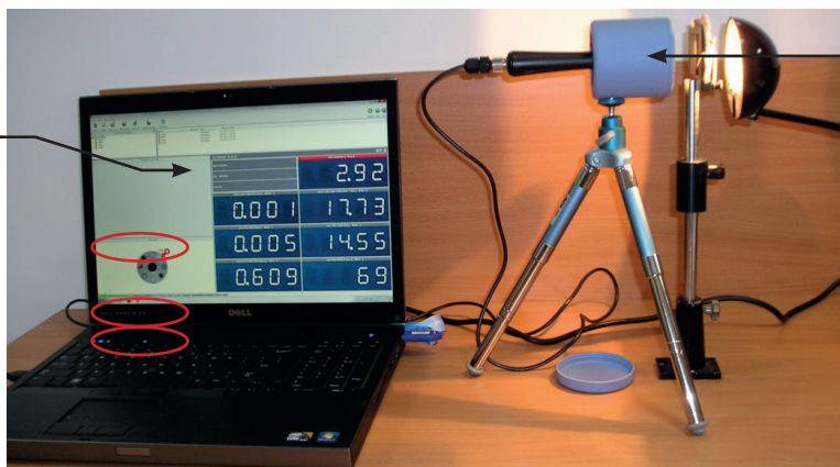
Ryc. 9. Zestaw pomiarowy do rejestracji mocy promieniowania cieplnego Fig. 9. Measuring equipment for identification of thermal radiation intensity
