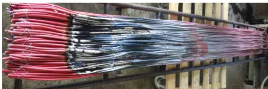
Rycina 4. Przykładowa próbka badawcza po badaniu wg PN-EN 60332-3-22
