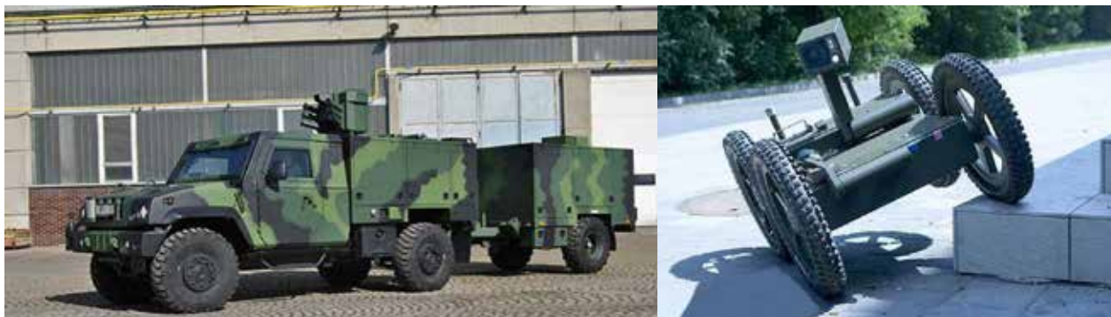
Rycina 13. Samochód do rozpoznania skażeń S-LOV-CBRN z samobieżnym robotem [46] Figure 13. The S-LOV-CBRN contamination reconnaissance car with a self-propelled robot [46]
