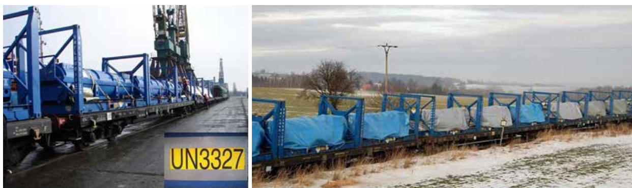
a) Pojemniki transportowe w ramach kontenerowych tworzące razem z paliwem sztuki przesyłki; b) Wagony z ładunkiem po oplandekowaniu [11]
