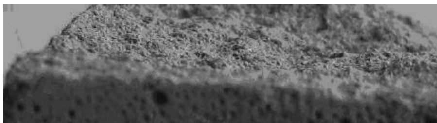
Рисунок 3 - Поверхность излома образца, армированного базальтовой фиброй “Минерал 7”
