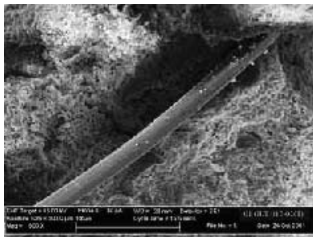
Рисунок 5 - Адгезия цементного вяжущего и полиамидного волокна [4]
