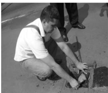
Рисунок 5 - Відбір керну та аналіз зчеплення гідроізоляційного матеріалу "Техноніколь" з асфальтобетонним покриттям та ортотропною плитою
