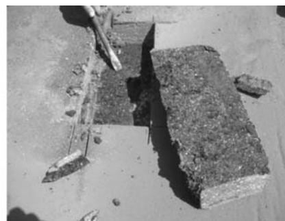
Рисунок 7 - Відбір керну та аналіз зчеплення гідроізоляційного матеріалу "Ребіт" з асфальтобетонним покриттям та ортотропною плитою
