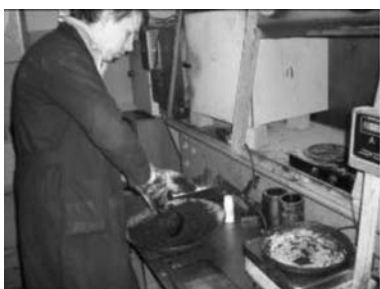
Рисунок 2 - Підготовка та виготовлення зразків на секторному пресі
