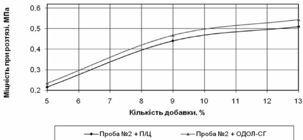
Рисунок 4 - Залежність міцності на розтяг при згині проби №2 при використанні різної кількості добавок
