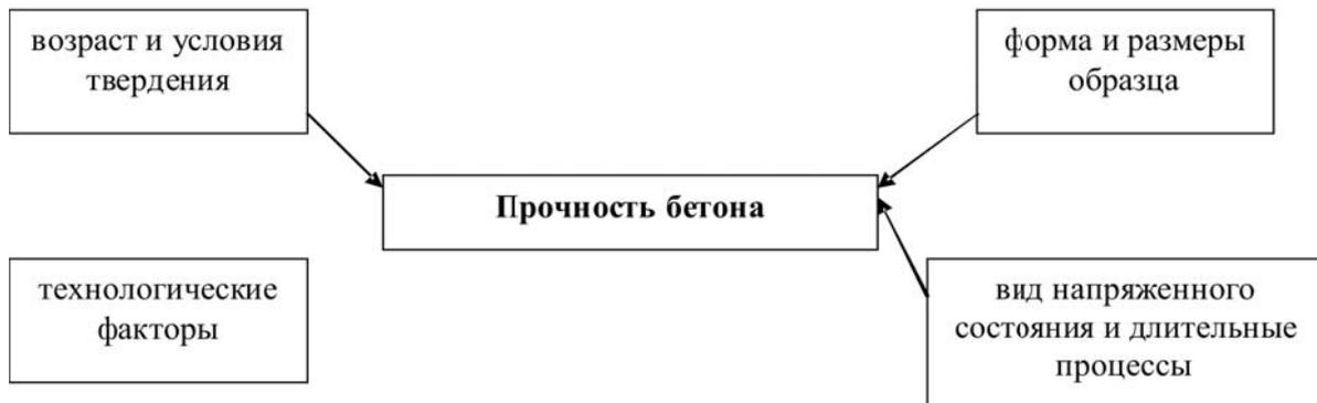
Рисунок 1 - Схема факторов, определяющих прочность бетона
