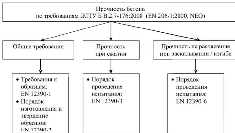
Рисунок 3 - Блок-схема связи ДСТУ Б В.2.7-176:2008 (EN 206-1:2000, NEQ) с неадаптированными стандартами EN
