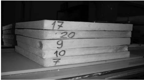
Рисунок 1 – Дослідні зразки пінополіуретану під час ресурсних випробувань: зліва направо - після 10-го циклу, після 60-го циклу
