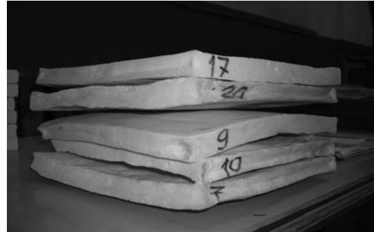
Рисунок 1 – Дослідні зразки пінополіуретану під час ресурсних випробувань: зліва направо - після 10-го циклу, після 60-го циклу
