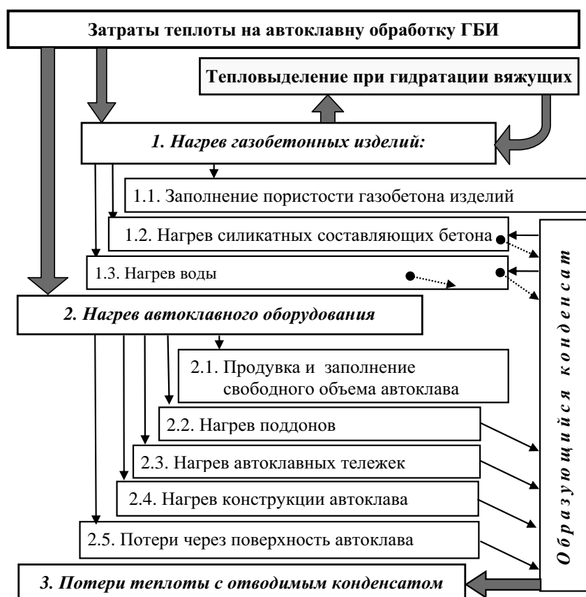
Рисунок 3 - Структура схема затрат теплоты на автоклавную обработку ГБИ
