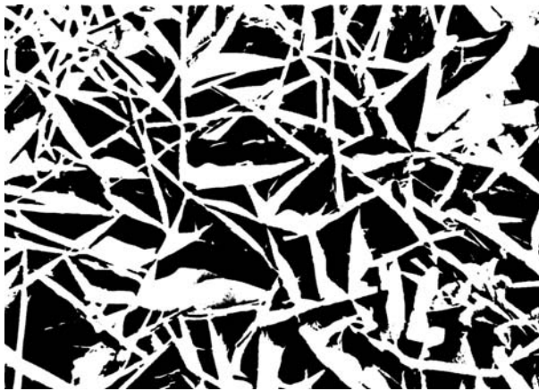
Рисунок 4 - Электронно-микроскопический снимок, выполненный методом реплик, со скола образцов бетона с \gamma = 450 \text{ кг/м}^3 , изготовленного по ударной технологии
