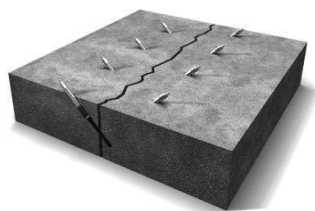
Рисунок 2: Расположение буровых пакеров
