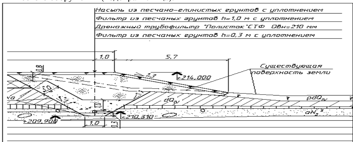
Рисунок 3. Защита от подтопления с использованием трубофильтра СТФ
