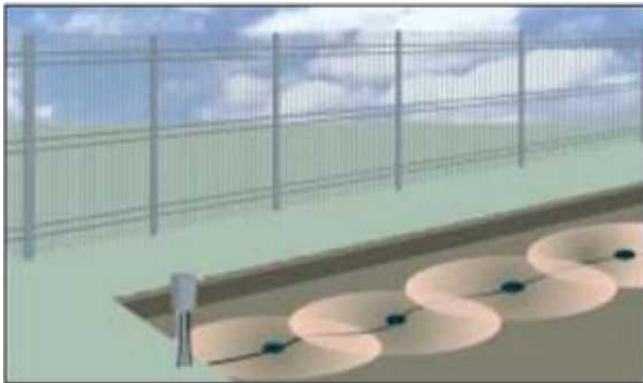
Рис. 2. Зона виявлення сейсмодатчиків і блок оброблення сигналів засобу «Годограф-СМ-С1»
