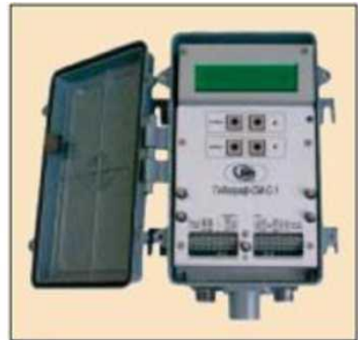
Рис. 2. Зона виявлення сейсмодатчиків і блок оброблення сигналів засобу «Годограф-СМ-С1»
