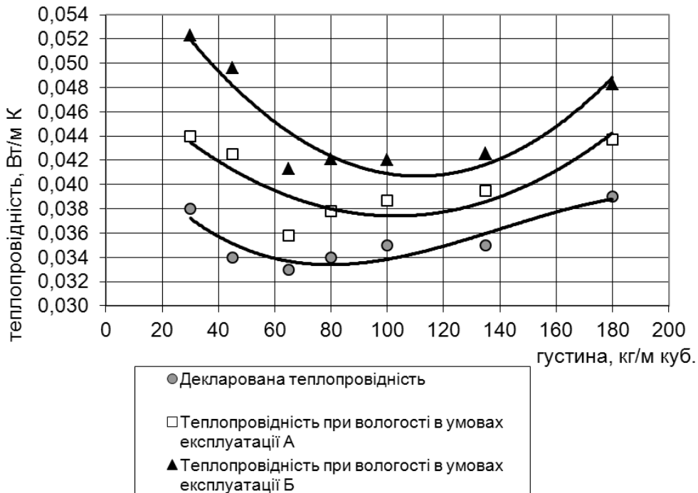
Рис. 2. Графік залежності теплопровідності від густини в різних станах зволоження мінеральної вати виробника №2
