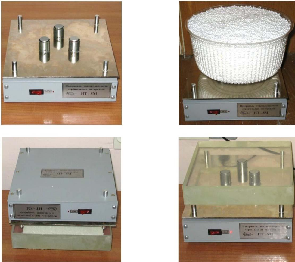
Рис. 3. Внешний вид прибора и варианты его расположения относительно образца
