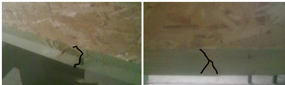
а) б) Рис. 3. Місце руйнування балки Б-1 (а) та Б-2 (б)
