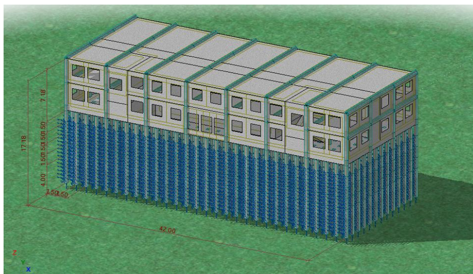
Рис. 2. Расчетная модель здания вокзала в программном комплексе Autodesk Robot
