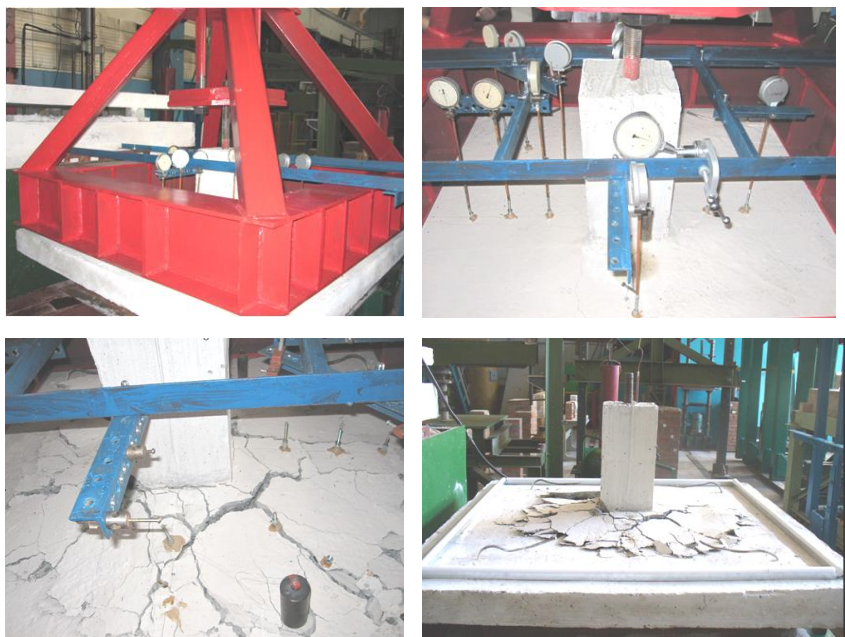
Рис. 3. Этапы продавливания при увеличении нагрузки
