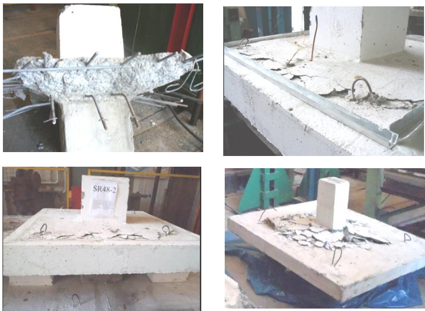
Рис. 16. Характер разрушения образцов второй серии
