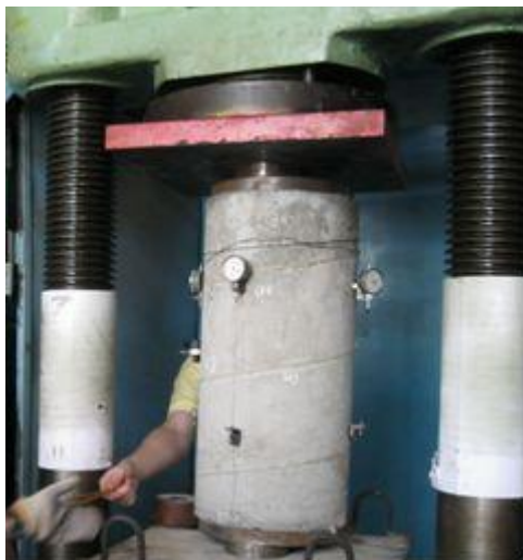
Рис. 3. Схема передачи нагрузки с заданным эксцентриситетом на образец
